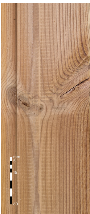
Šakų skilimai lentos briaunose A rūšis: Leidžiama iki 1/10 lentos pločio B rūšis: Leidžiama, neribojama
