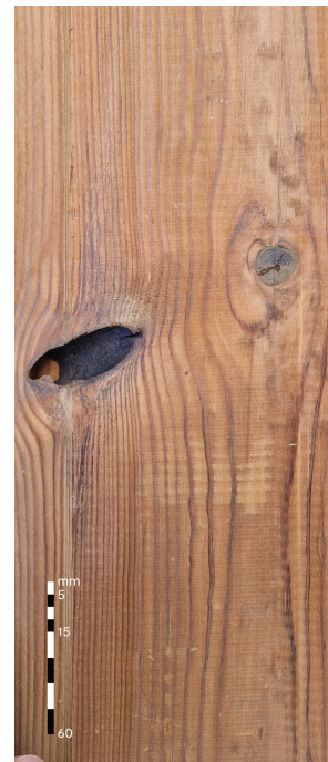
Kiaurai iškritusios šakos A rūšis: Draudžiama B rūšis: Leidžiama, iki 20 mm pločio, ne daugiau 1 vnt. x lentos ilgis, m
