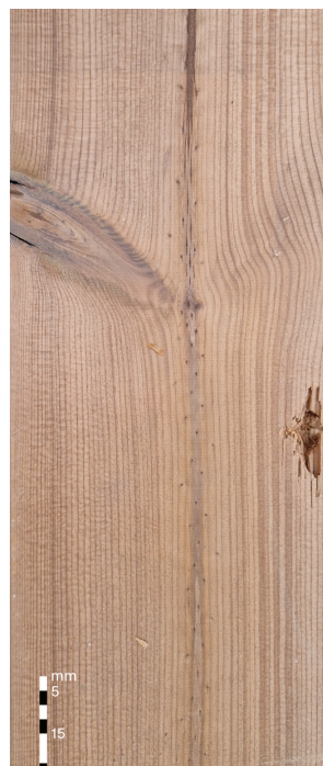
Mechaniniai pažeidimai A rūšis: Draudžiama, išskyrus 80 mm lentos galuose B rūšis: Leidžiama iki 300 mm ilgio, ne daugiau 0,5 vnt. x lentos ilgis, m
