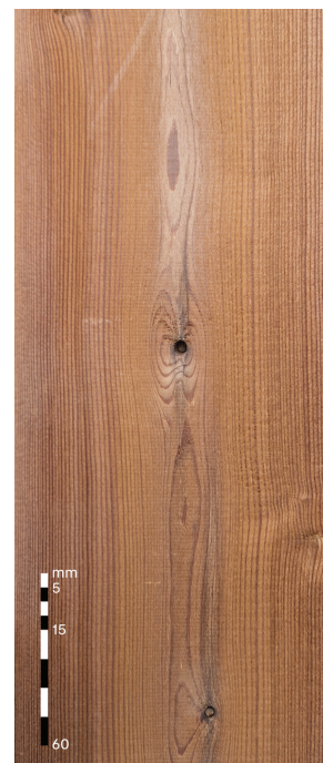
Negyvos neiškritusios šakos A rūšis: Leidžiama, iki 1/10 lentos pločio, siauriausioje šakos vietoje B rūšis: Leidžiama, neribojama
