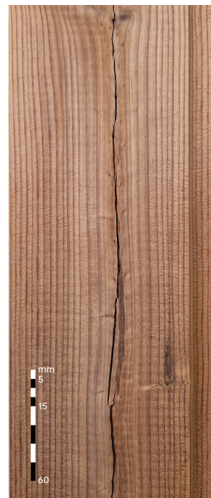
Paviršiniai skilimai A rūšis: Leidžiama iki 150 mm ilgio B rūšis: Leidžiama, neribojama
