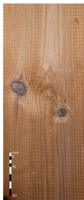
Šakos su perimetriniu skilimu A rūšis: Leidžiama, iki Ø 20 mm. B rūšis: Leidžiama, neribojama
