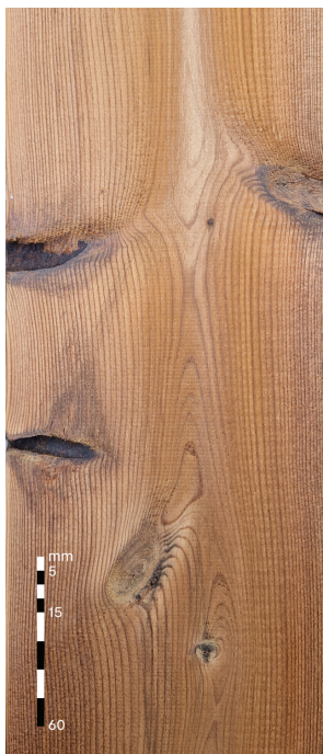
Šoninėje kraštinėje iškritusios šakos A rūšis: Leidžiama, iki 15 mm pločio B rūšis: Leidžiama, neribojama
