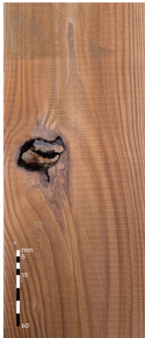
Ištrupėjusios šakos A rūšis: Leidžiama, iki 1/10 lentos pločio B rūšis: Leidžiama, neribojama
