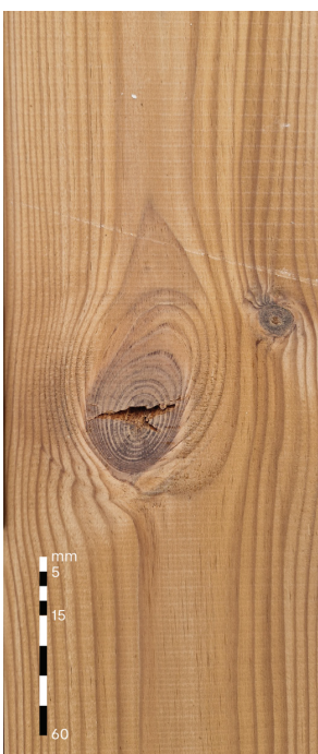
Skilusios šakos A rūšis: iki 5 mm pločio ir 50 mm ilgio B rūšis: Leidžiama, neribojama
