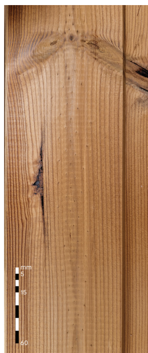
Sakų kišenės A rūšis: Leidžiama, iki 200 mm ilgio B rūšis: Leidžiama, neribojama
