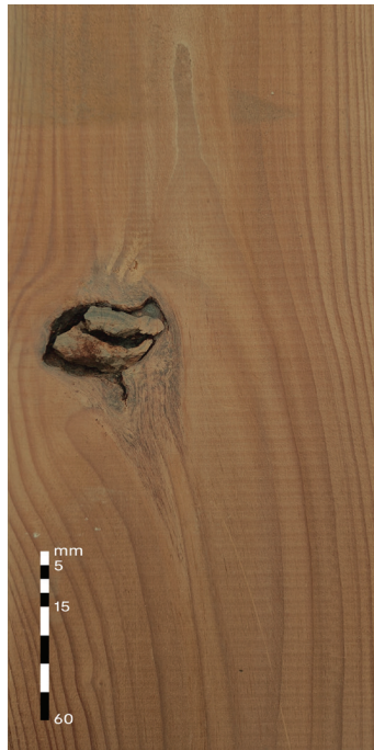
Ištrupėjusios šakos A rūšis: Leidžiama, iki 1/10 lentos pločio B rūšis: Leidžiama, neribojama
