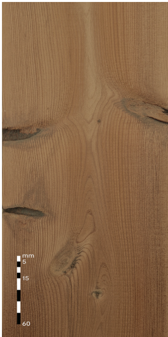
Šoninėje kraštinėje iškritusios šakos A rūšis: Leidžiama, iki 15 mm pločio B rūšis: Leidžiama, neribojama
