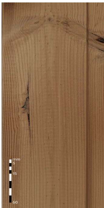
Sakų kišenės A rūšis: Leidžiama, iki 200 mm ilgio B rūšis: Leidžiama, neribojama
