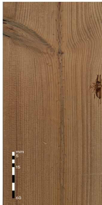
Mechaniniai pažeidimai A rūšis: Draudžiama, išskyrus 80 mm lentos galuose B rūšis: Leidžiama iki 300 mm ilgio, ne daugiau 0,5 vnt. x lentos ilgis, m
