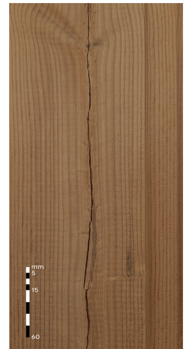
Paviršiniai skilimai A rūšis: Leidžiama iki 150 mm ilgio B rūšis: Leidžiama, neribojama
