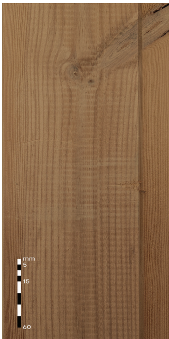
Obliavimo žymės (nuo 0.5 mm gylis) A rūšis: Draudžiama B rūšis: Leidžiama, neribojama
