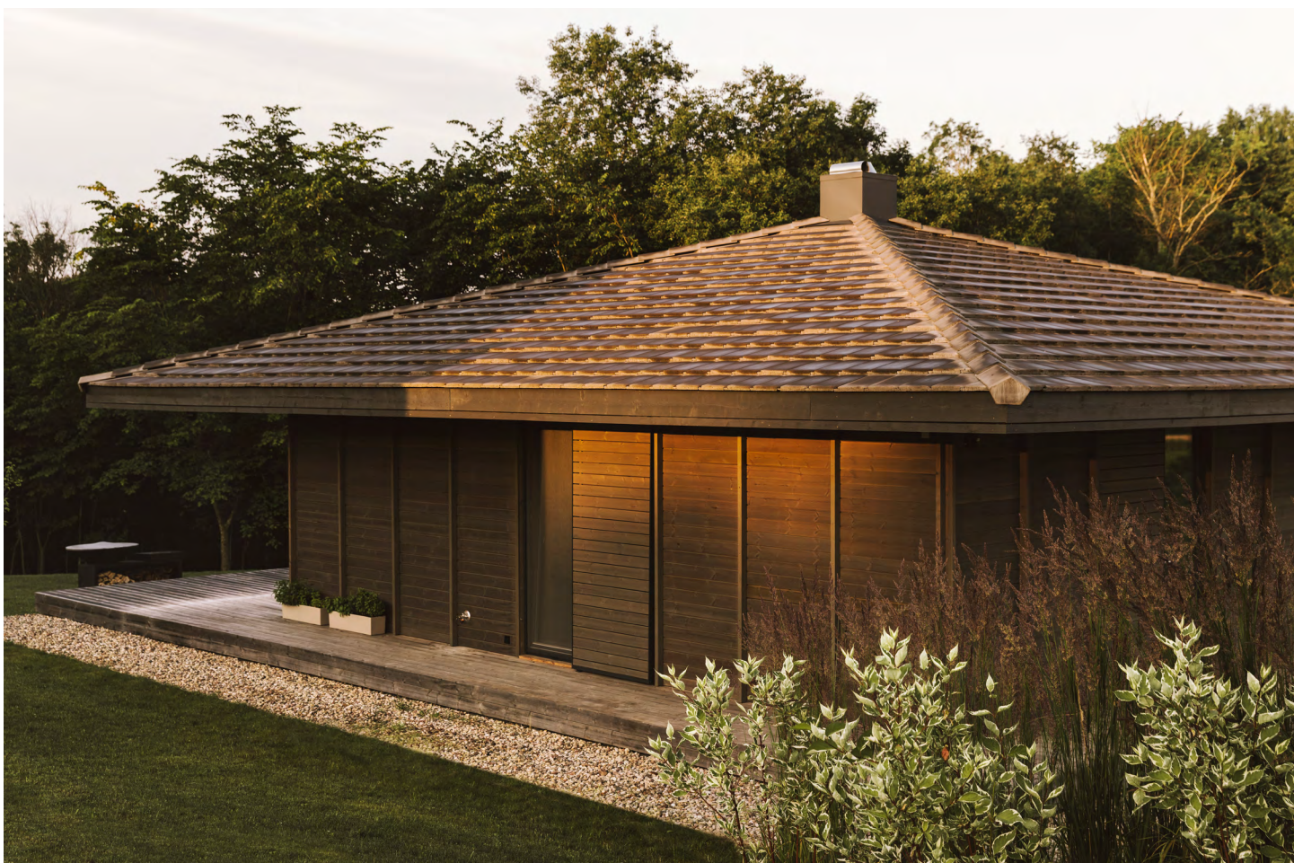
Projekt „Gervé” // Architekci: Šilta šiaurė // Profil: Listwa 42x42, Tikkurila Wood Stain 5083 // Rūta 19x117 Tikkurila Wood 5083 // Zdjęcie: Algirdas Bakas
